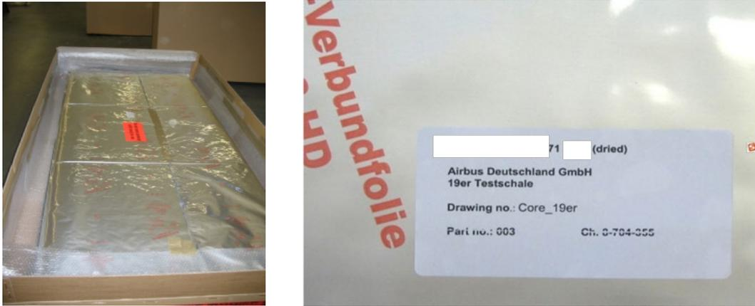
图5、泡沫板材采用镀铝塑料膜包装，泡沫保持干燥状态
