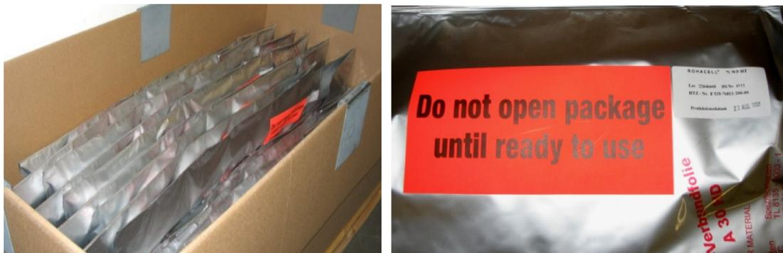
图6、经过热处理的泡沫，采用镀铝薄膜密封
