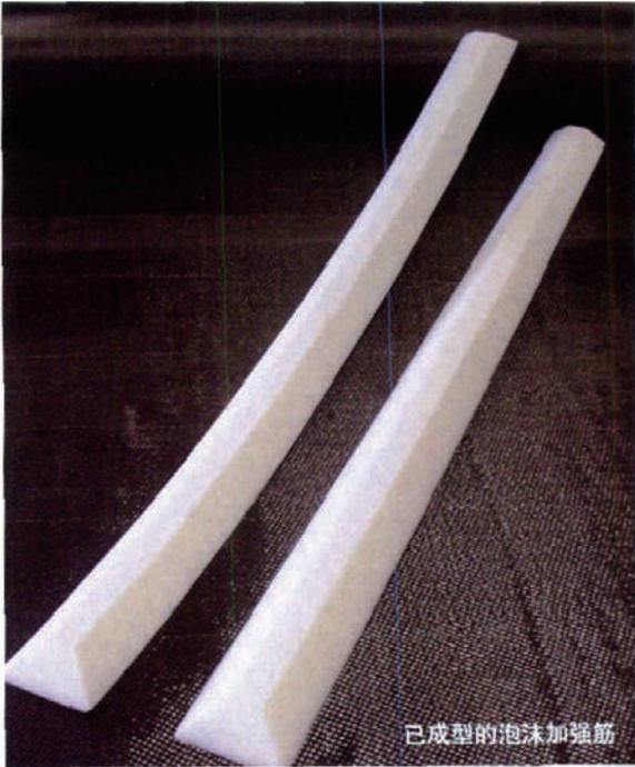
到一定的结构作用<sup>[2]</sup>。因为泡沫的压缩强度很高,它可以提高结构的稳定性,减少夹层结构中预浸料铺层,达到减重的目的。
