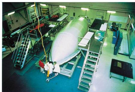
图 16 铺层结束，进罐前的 Delta II 的有效载荷整流罩
